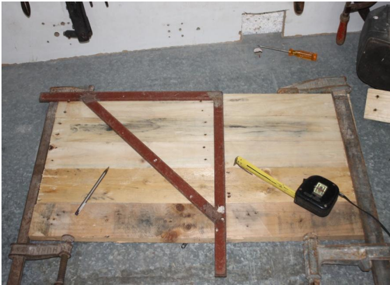
Detalle de unos listones alineados y medidos a escuadra listos para cortar. Foto: Fernando Calderón.
